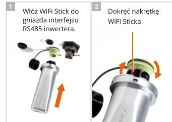
Gniazdo interfejsu RS485 służące do podłączenia urządzeń peryferyjnych
