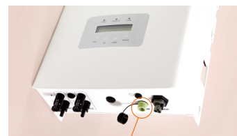
Gniazdo interfejsu RS485 służące do podłączenia urządzeń peryferyjnych
