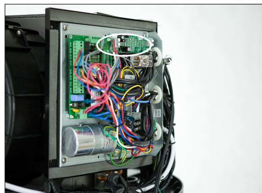
Zdjęcie po lewej: pręt anody tytanowej Zdjęcie po prawej: płytka sterująca z zaznaczoną płytką anody tytanowej
