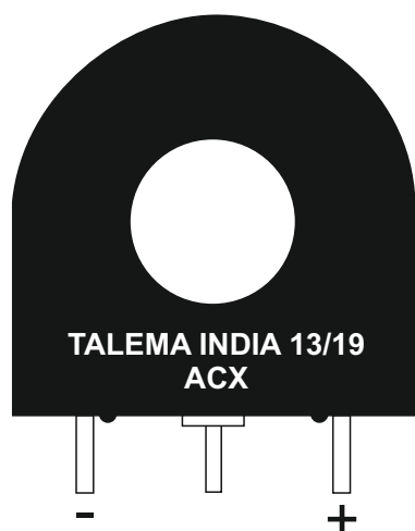
Rys. 5. Lokalizacja pinów przekładnika ACX
